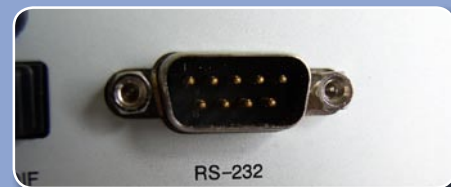
На большинстве ресиверов можно найти порт RS-232 для соединения с компьютером
