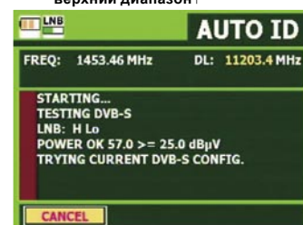
Автоматическое вычисление скорости потока и FEC
