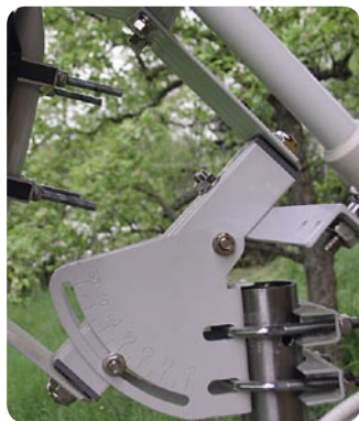
Шкала широты используется для установки антенны в соответствии с географической широтой места
