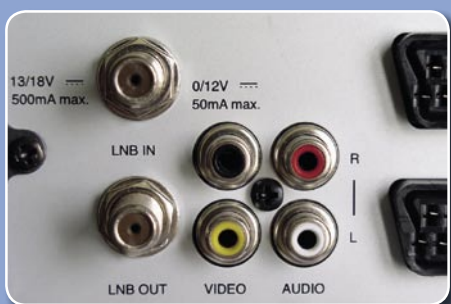
Обычные разъемы для конвертера и звука
