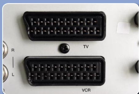
Привычные для европейских ресиверов SCART-разъемы – для телевизора и видеомagneтофона
