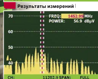
Спектр спутника HotBird (13 в.д.), горизонтальная поляризация, верхний диапазон
