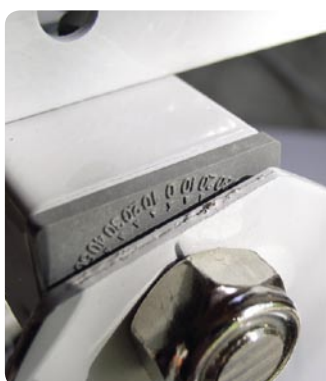
Шкала угла поворота для ручной юстировки
