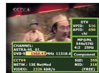
Отображение сигнала в режиме DVB-S
