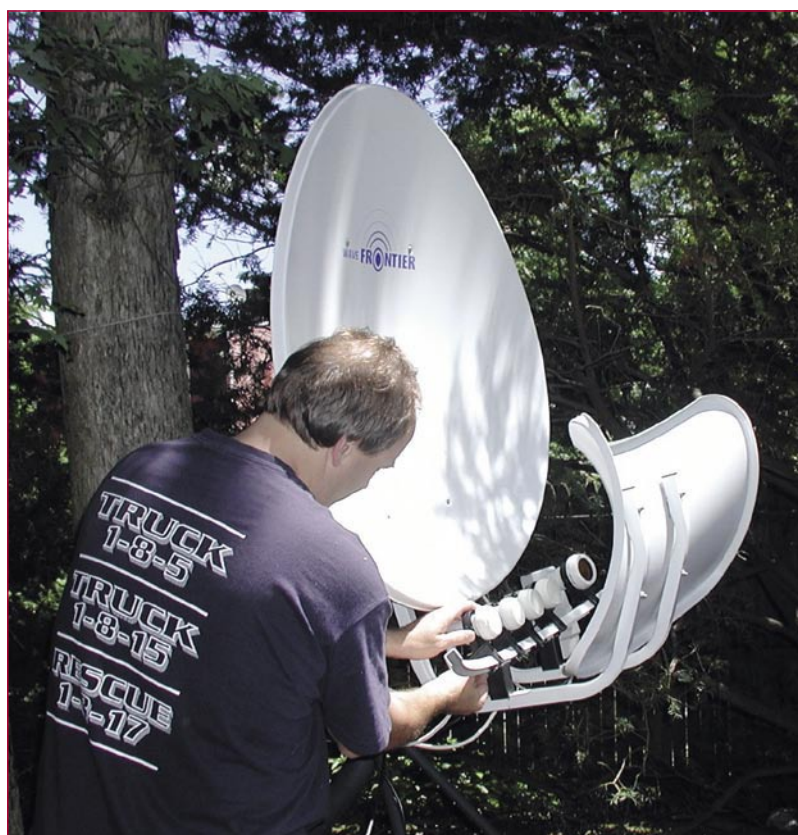
Редактор ТЕЛЕ-спутелайт Рон Роессел устанавливает конвертеры на «рельс» антенны Wavefrontier Toroidal T90 на антенной площадке центра тестирования ТЕЛЕ-спутелайт в пригороде Нью-Йорка
